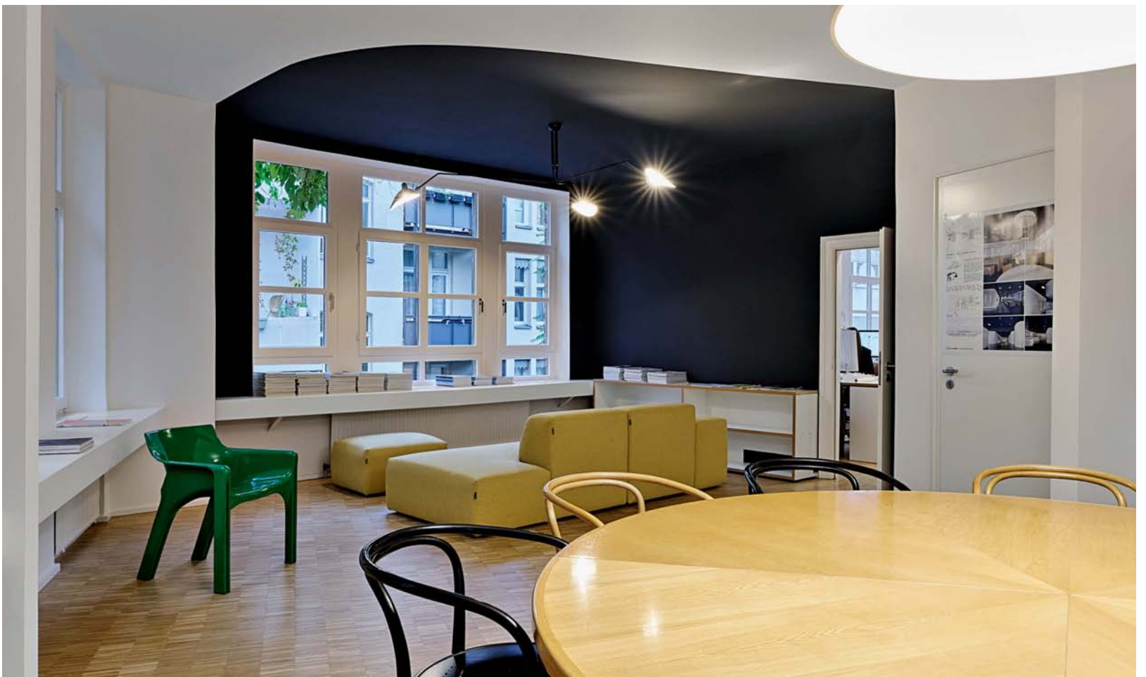
Partiell abgehängte Decken sowie Farbflächen in Mattschwarz gliedern die Räume in Funktionsbereiche. • Partially suspended ceilings and surfaces coloured in matt black divide the rooms into functional areas.
